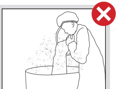
**Não. Porquê?** O trabalhador despeja o saco longe da amassadeira, levantando pó, sem que o equipamento tenha aspiração e nem sequer usa máscara.
