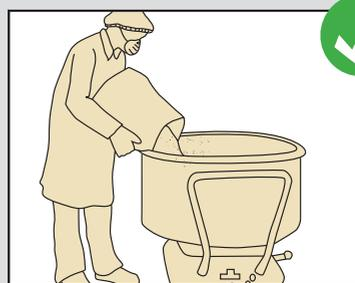
**Sim. Porquê?** O trabalhador despeja o saco próximo do recipiente sem levantar pó.
